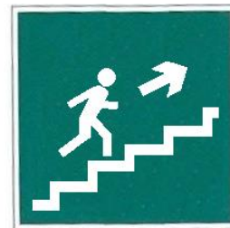
Направление к эвакуационному выходу по лестнице вверх
